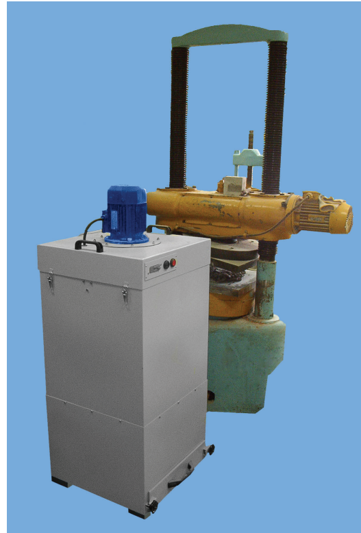
АОУМ-800 Лабораторные испытания образцов железобетона на прочность
