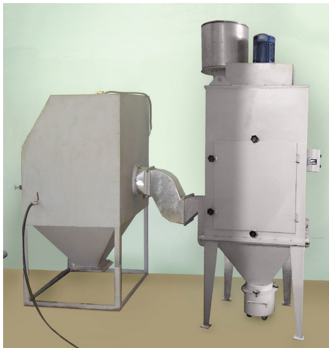
АОУМ-2000-ПС Участок пескоструйной обработки
